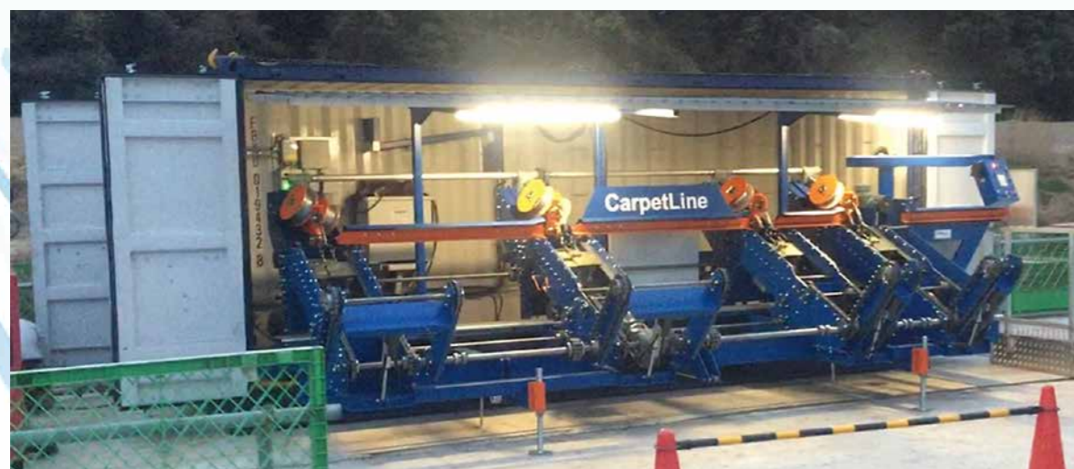
20フィートコンテナに格納された加工機械を現場内に配置して加工できます
